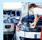
Funktionsprüfung vorher/nachher, Wechsel und vollständiges Auffüllen des Kältemittels, Dichtheitsprüfung. Bei Bedarf Austausch des Innenraumfilter (nicht im Preis enthalten)
